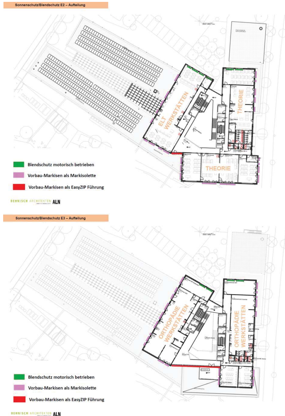
Abbildung 15: Übersicht der innen und außen liegenden Systeme in E2 und E3
