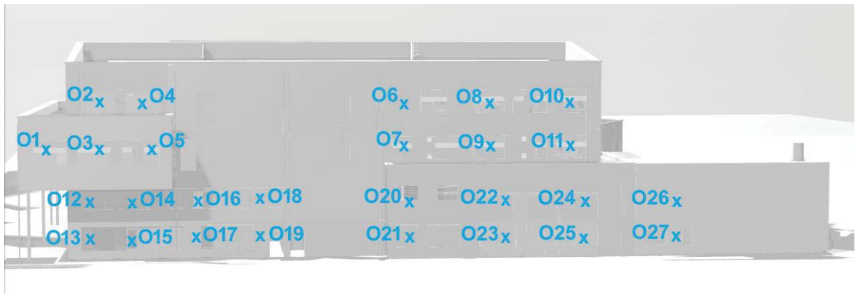
Abbildung 19: Ansicht Ost mit Geschwindigkeitsmessstellen O1 bis O27 vor der Fassade
